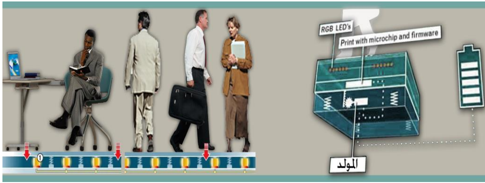
شكل ( ٢٣ ) يوضح تركيب الارضية فوق مجموعة من الزنبرك متصلة بسلسلة من وحدات البيزوكريستال التي تقوم بتحويل طاقة الحركة الى طاقة كهربائية
